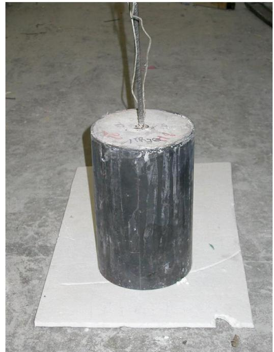
Illustration 7: Ancrage d'une armature dans un cylindre de béton cerclé d'acier
